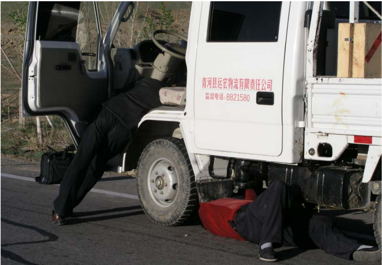
Keine Expedition ohne Probleme mit den Fahrzeugen: Der ausgehakte Gaszug war glücklicherweise nach zehn Minuten wieder repariert.
