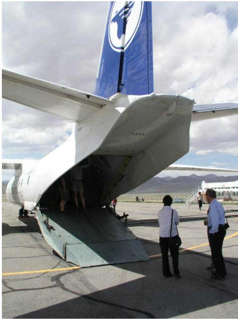
Die große Heckklappe verrät die militärische Herkunft der Antonov AN-26
